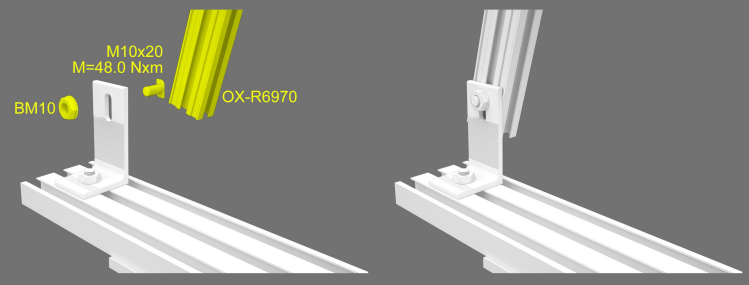
2. Montaje de Rail Omnia Montante sobre L-FOOT
