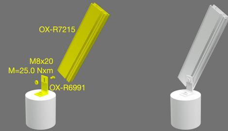
2. Montaje de Perfil Ace montante sobre L-FOOT
