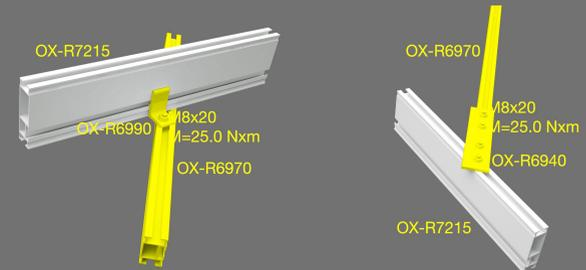
6. Instalación del punto de fijación del cortaviento diagonal con la correa horizontal
