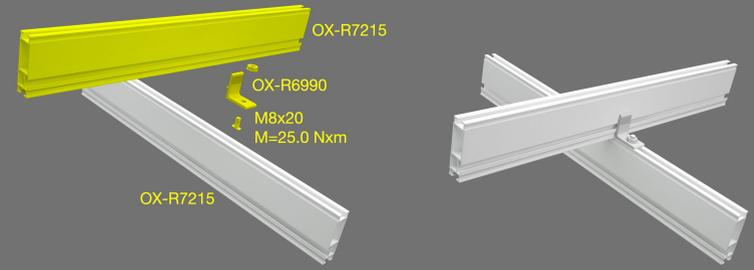
4. Montaje de Perfil Ace correa sobre Perfil Ace diagonal
